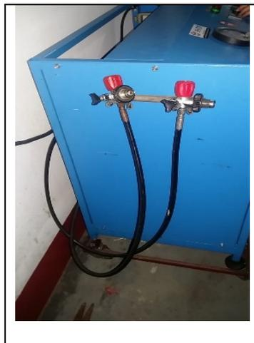
**4 - Válvula de segurança e manômetro:** Exigido pelas normas internacionais nos compressores de alta pressão. Tanto a válvula de segurança final, que é acionada no caso da pressão passar do limite de segurança e o Manômetro da saída do compressor, tem que estar em perfeito funcionamento. O Manômetro do compressor, deve indicar a pressão que esta no cilindro. **Atenção:** é possível comparar o manômetro do compressor com o cilindro, eles devem coincidir.
